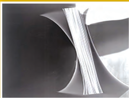
รูปที่ 2 การโค้งงอของปกหนังสือ และเนื้อในเป็นคลื่น เกิดจากเกรนกระดาษไม่สัมพันธ์กับแนวสันหนังสือ
