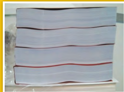
รูปที่ 2 การโค้งงอของปกหนังสือ และเนื้อในเป็นคลื่น เกิดจากเกรนกระดาษไม่สัมพันธ์กับแนวสันหนังสือ
